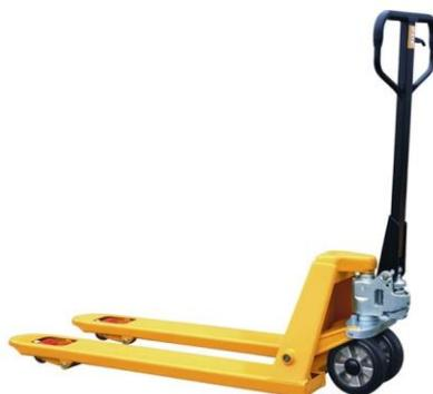
Esempio di transpallet manuale da 2500 kg
