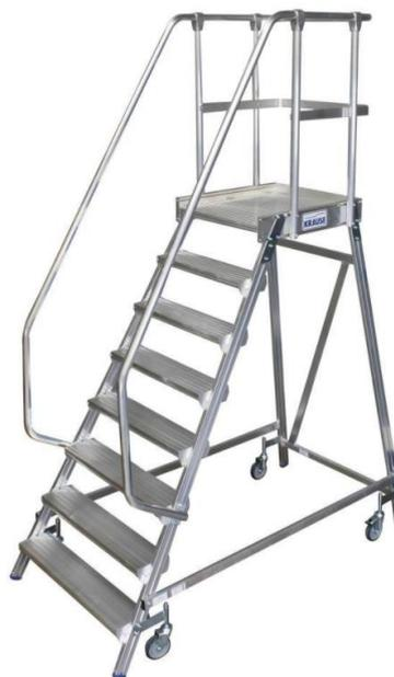
La scala è a salita singola con piattaforma in alluminio resistente alla corrosione e agli agenti atmosferici, molto robusta e certificata secondo EN 131, BGI 637, BGI 694 e BGV-D 36; movimento è garantito da 4 ruote girevoli del diametro di 125 mm, con compressione automatica durante l'impiego, di cui 2 con freni di bloccaggio.
