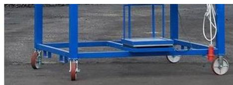
Ruotine per spostamento di cui due fisse e due piroettanti con freno
